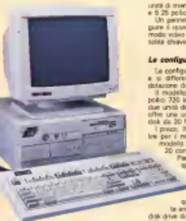
quali: adattatore video compatibile CGA ed Hercules monocromatico, orologio/batteria in tempo reale con batteria di backup, controller integrato per dischetti, interfaccia parallela Centronics, interfaccia seriale RS 232C, porta per mouse e porta per joystick.
